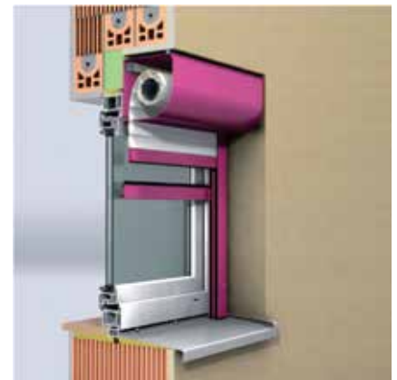
Außenrollladen mit halbrunden Rollladenkasten und Insektenschutz-Rollo
