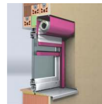
Zunanja roleta s polokroglo omarico in rolo komarnikom
